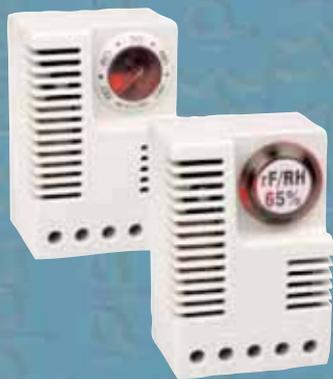
L'igrostatto elettronico sorveglia l'umidità relativa all'interno di quadri elettrici ed alloggiamenti contenenti componenti elettrici/elettronici e mette in funzione il riscaldamento al raggiungimento del valore impostato, impedendo la formazione di condensa. Il LED integrato si accende quando il riscaldatore collegato è in funzione.
